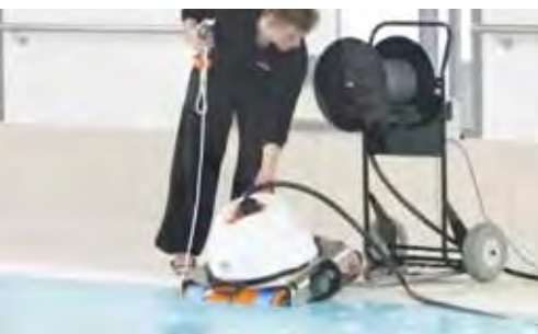
Le robot va tout seul à l'eau. Il possède une poignée centrale en inox pour le sortir très facilement du bassin.
